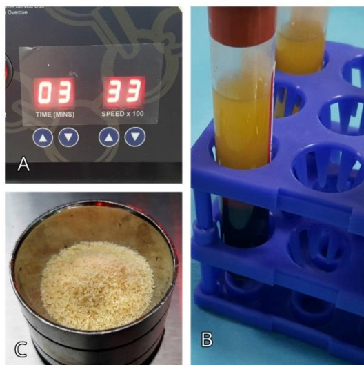
Figura 1 – A – Velocidade de 3.300rpm por 3 minutos (equivalentes a 600 g nesta centrífuga); B- Tubos estratificados após
